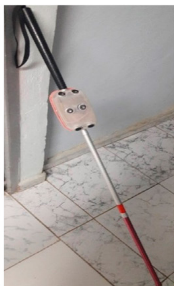
Figura 6. Esquema de disposición de los sensores en el batón (izquierda) y foto del prototipo con los dos sensores ultrasónicos y el “Smartphone”.
