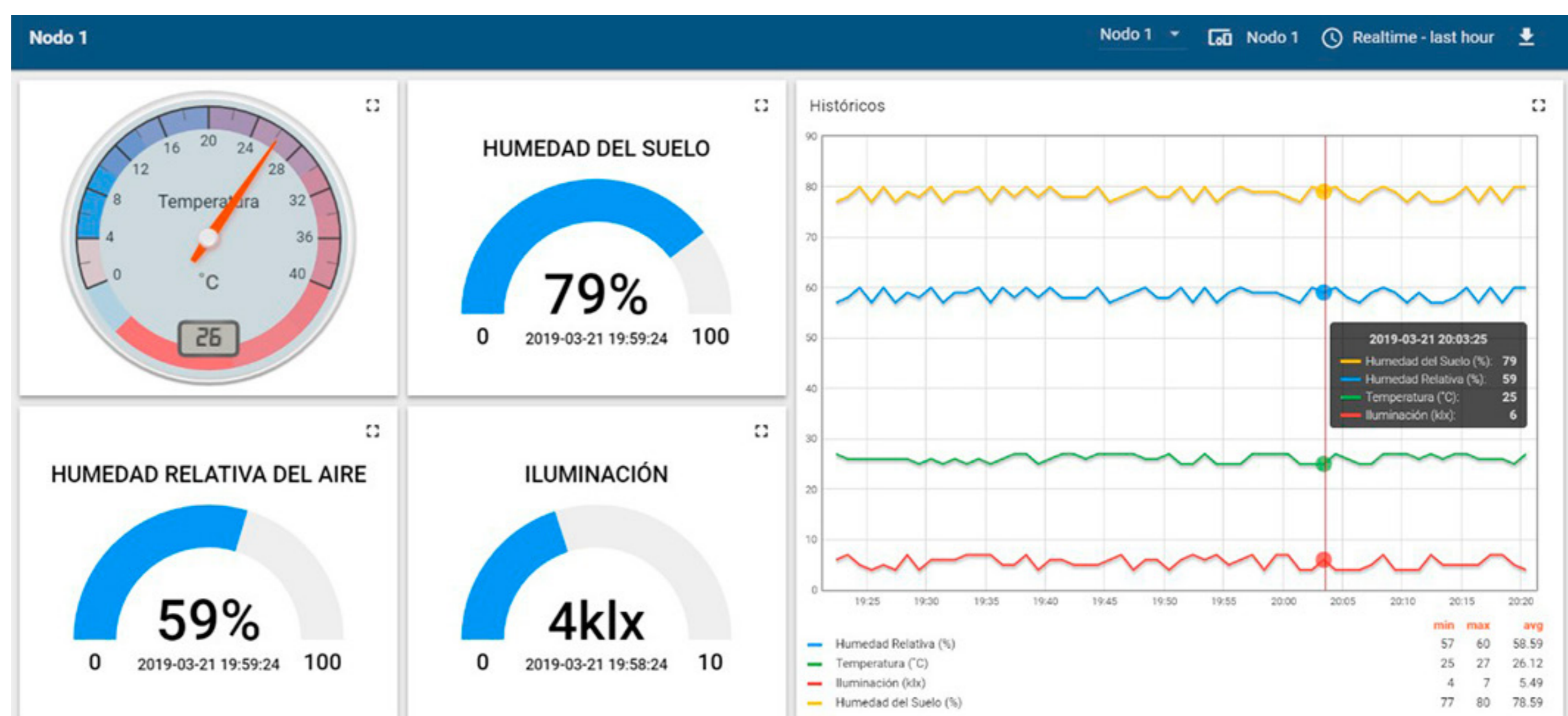
Figura 2. Panel de visualización de los datos de un nodo en la plataforma ThingsBoard .
