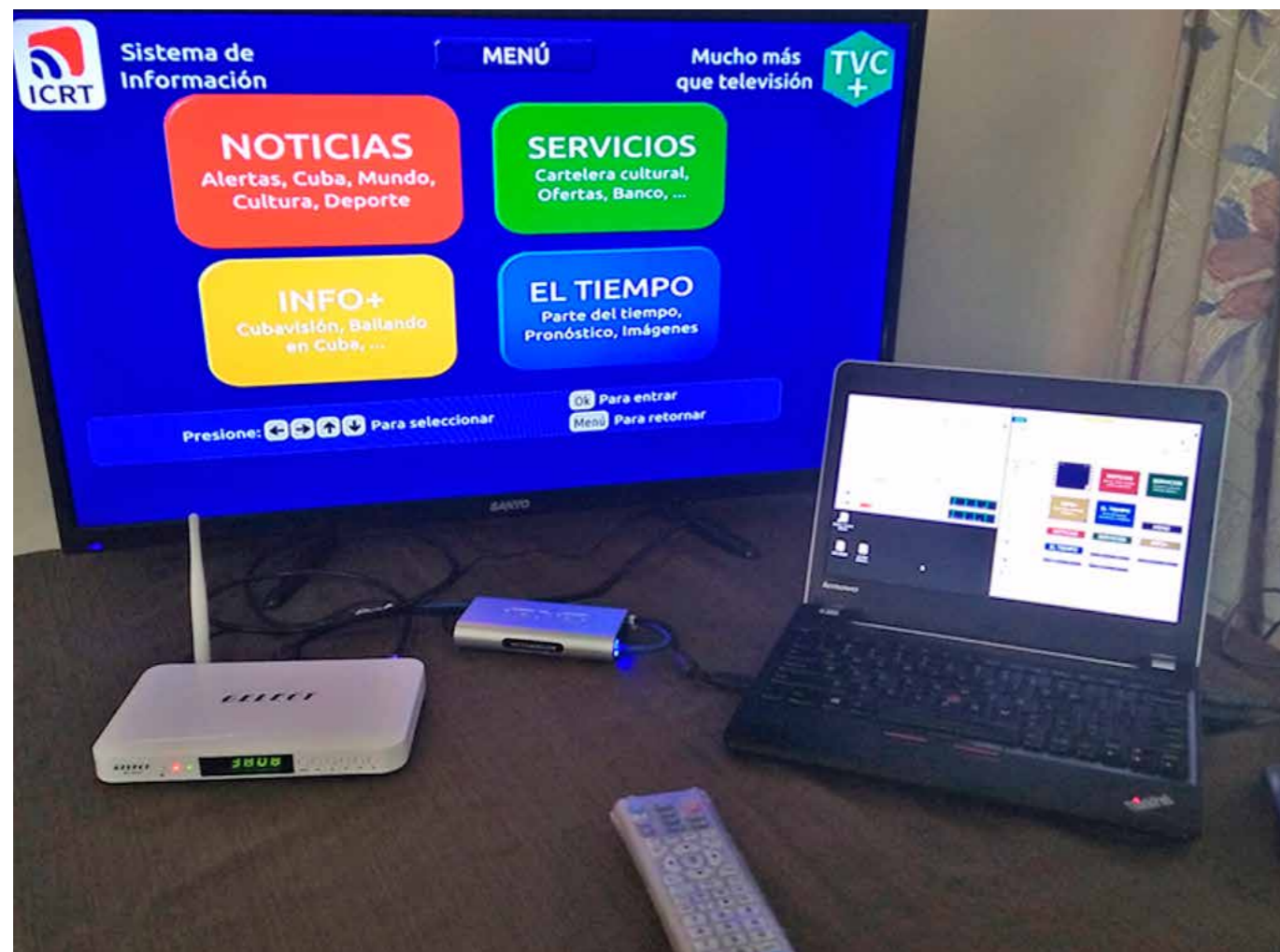
Fig. 4 Escenario de prueba, donde se muestra el modulador (en el centro) que transmite la señal generada en la PC y finalmente se visualiza en el televisor desde el STB.
